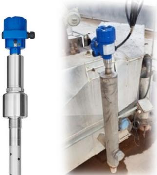
*TDR-Sensoren mit Koaxialsonden sind die zuverlässigste Art der Füllstandbestimmung. Eine beliebte Installationsart für TDR-Sensoren ist der Bypass. Der Effekt des Bypassrohres ist vergleichbar mit dem eines Koaxialrohres.*
