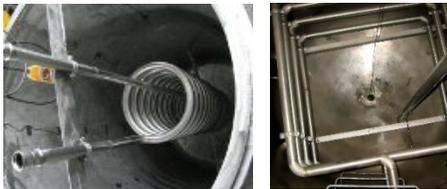
*Heizspindel im inneren eines Tanks: Für TDR-Sensoren mit Koaxialsonde kein Problem. Auch Heizschlangen sind mit Koaxialsonde keine Störquelle.*
